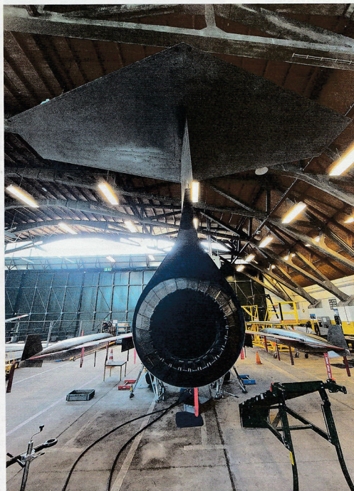
Heckansicht der D-8114. Das Strahltriebwerk General Electric J79-GE-11A fehlt
