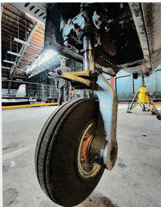
Für Hydrauliktests wurde die D-8114 aufgebockt. Im Bild das Bugrad ...
