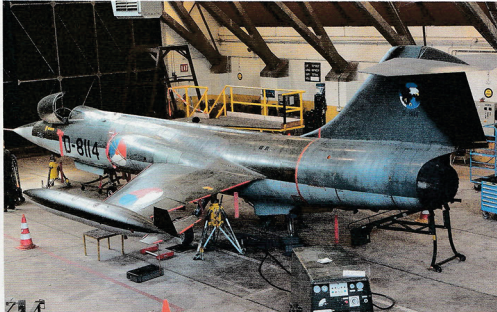
Scharfe Kanten und herausstehende Bauteile sind extra verkleidet und der Schleudersitz deaktiviert, um Unfällen vorzubeugen
